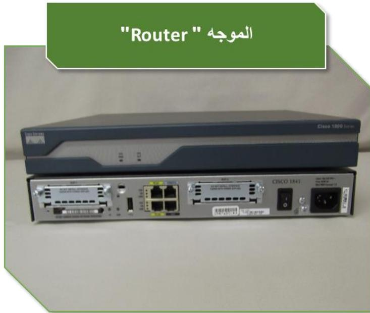
شكل رقم ٢١: موجه من شركة سيسكو "Cisco Router"
